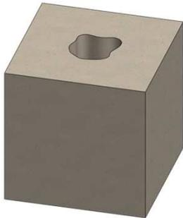
**Etape 2 :** Mettre le poteau en place et verser le béton
